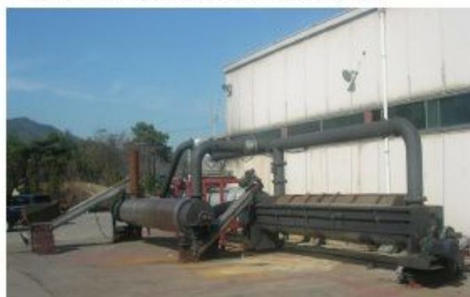
现代建设(福州) 有机污泥干燥/碳化设备
