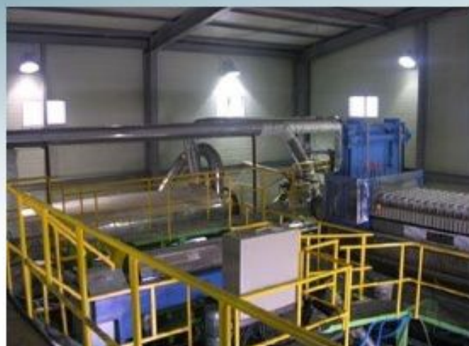
现代建设(福州) 有机污泥干燥/碳化设备
